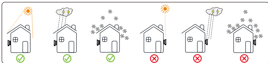
图 5.3 光储一体机安装环境示意
